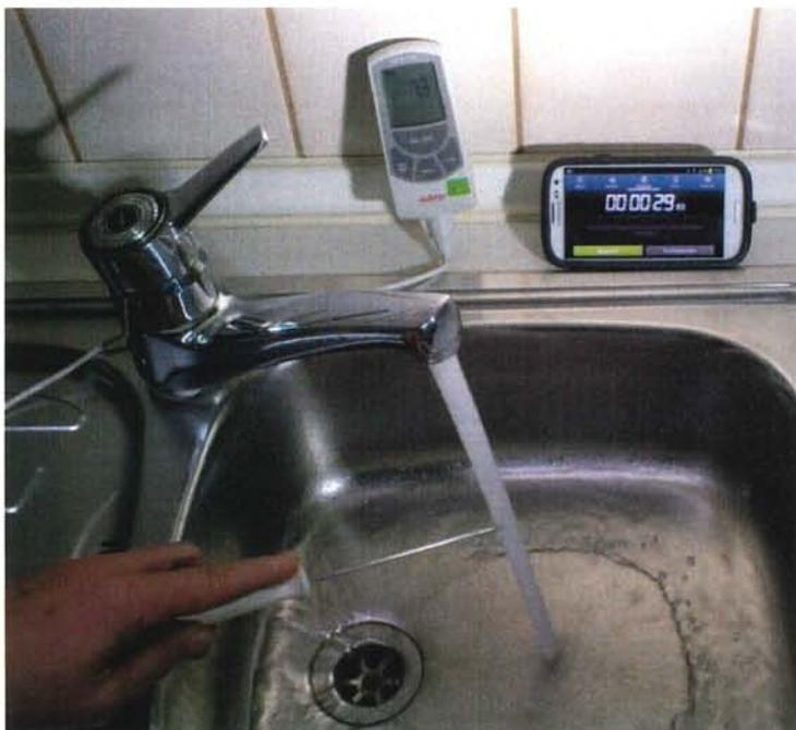
Bild 5: Überprüfung der Kaltwassertemperatur
