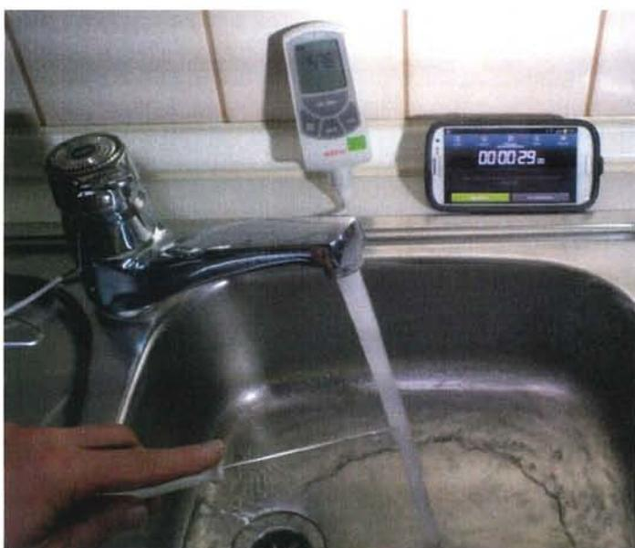
Bild 6: Überprüfung der Warmwassertemperatur
