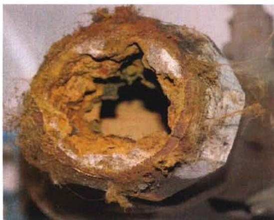
Bild 10: Zugewachsenes Trinkwasserrohr
